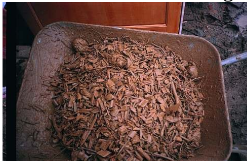
Holz hackschnitzel in Lehmschlämme
